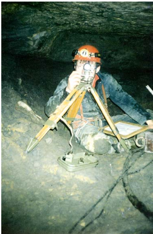
Fig. 6 Nivellement près du puits 5
